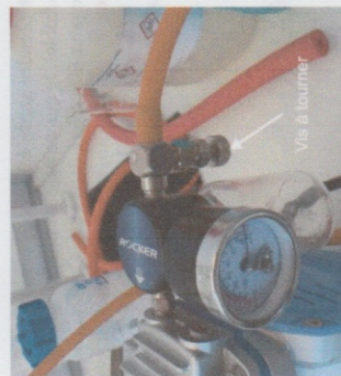
Figure 3 – Vis permettant de jouer sur le niveau de dépression appliqué
