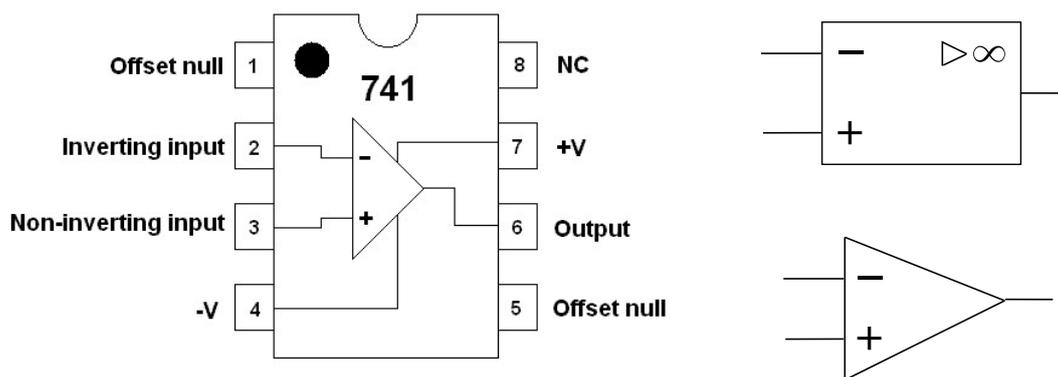
FIGURE 25 – *Gauche* : vue de dessus d'un AO  $\mu A741$  (le point noir désigne toujours la broche 1). *Droite* : représentation symbolique d'un AO, les bornes d'alimentation sont implicites.
