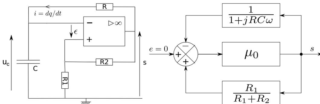
FIGURE 57 – Gauche : Montage multivibrateur astable. Droite : Schéma bloc fonctionnel équivalent.
