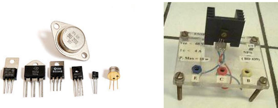
FIGURE 98 – Gauche : des transistors. Droite : transistor bipolaire npn de la prépa agrégé monté sur son dissipateur thermique.
