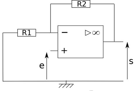
$\underline{H}(j\omega) = 1 + \frac{R_2}{R_1}$ <p>si <math>R_2 = 0</math> et <math>R_1 = \infty</math>, le montage est suiveur</p> |
