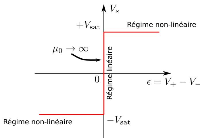
FIGURE 27 – Caractéristique entrée-sortie de l'AO idéal. Lorsque  $\epsilon = 0$ ,  $V_s$  est imposé par le reste du circuit.
