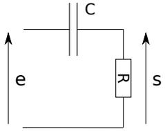
$\underline{H}(j\omega) = \frac{jRC\omega}{1 + jRC\omega}$ |
