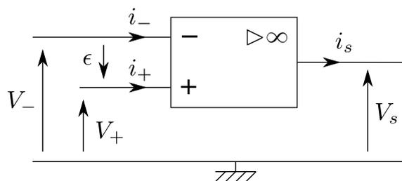
FIGURE 26 – Représentation symbolique d'un amplificateur opérationnel idéal et sa paramétrisation électrique.
