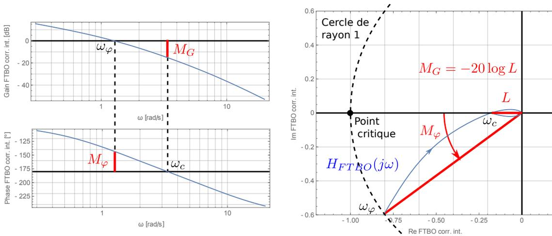
FIGURE 52 – Marges de gain  $M_G$  et de phase  $M_\varphi$  représentées sur les diagrammes de Bode (gauche) et de Nyquist (droite) pour une fonction de transfert à boucle ouverte  $H_{FTBO}(j\omega)$  telle que présentée section 5.4.3.
