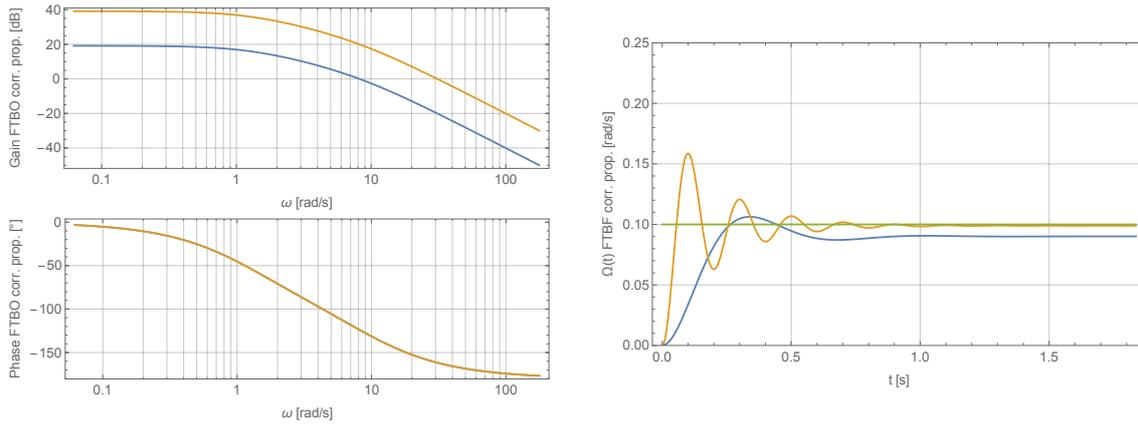
FIGURE 45 – *Gauche* : diagrammes de Bode de la fonction de transfert  $H_{FTBO}^c(p)$  avec correction proportionnelle pour  $K_c = 1$  (bleu), 10 (jaune). *Droite* : réponse temporelle de la boucle fermée associée à la fonction de transfert  $H_{FTBF}^c(p)$  avec correction proportionnelle pour  $K_d = 10$  et différentes valeurs  $K_c = 1$  (bleu), 10 (jaune) pour un échelon de commande (vert) : la précision et la rapidité augmentent avec  $K_c$  mais les oscillations se renforcent.
