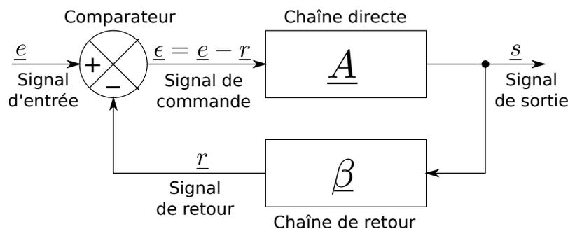
FIGURE 37 – Schéma fonctionnel unifilaire général d'un système bouclé.
