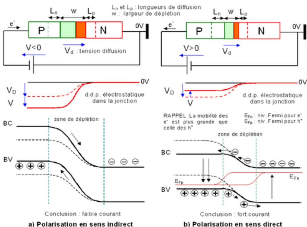
FIGURE 93 – Fonctionnement d'une jonction pn polarisée. (Source : <http://www.optique-ingenieur.org>)
