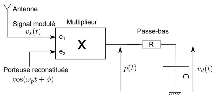
FIGURE 68 – Principe de la démodulation par détection synchrone.
