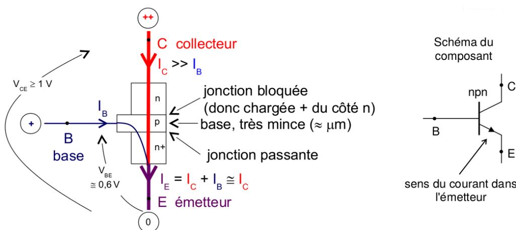
FIGURE 100 – Présentation du transistor npn.
