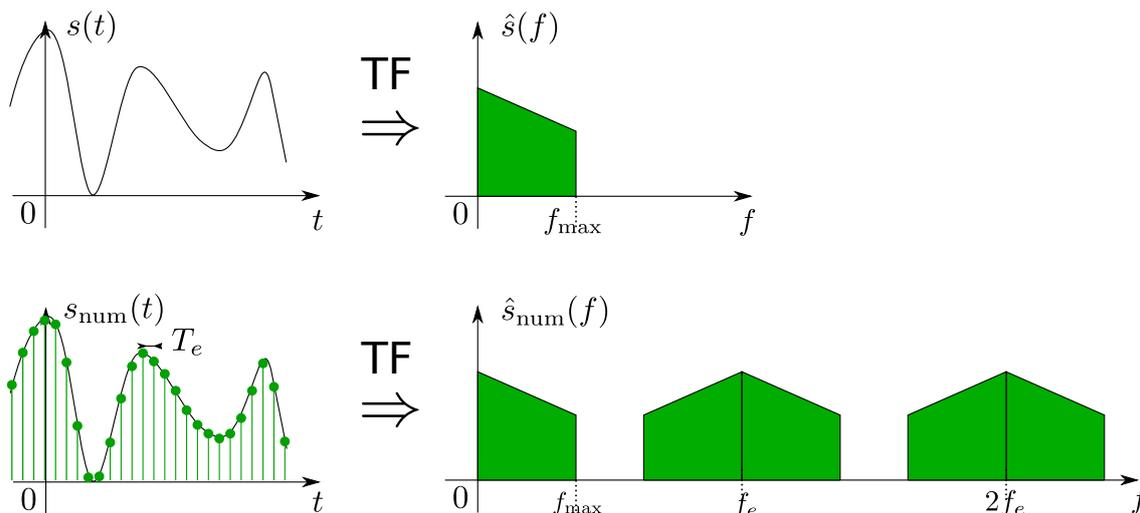
FIGURE 79 – Effet de l'échantillonnage d'un signal  $s(t)$  sur son spectre de Fourier.
