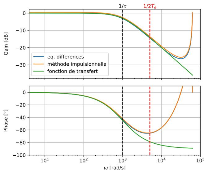
FIGURE 90 – Diagrammes de Bode d'un filtre numérique passe-bas réalisé selon trois méthodes, avec  $\tau = 1$  ms et  $T_e = \tau/10$ .
