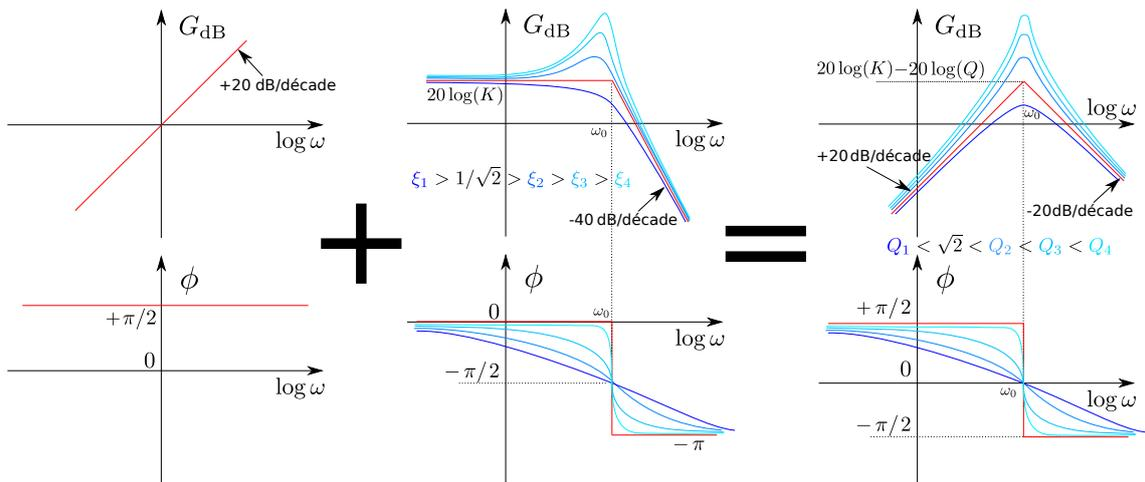
FIGURE 22 – Construction des diagrammes de Bode d'une fonction de transfert passe-bande du second ordre dans le cas  $0 < \xi < 1 \Leftrightarrow Q > 1/2$ . Pour les besoins du dessin, un seul diagramme asymptotique est représenté pour les différents  $Q_i$ , mais son maximum se situe à  $20 \log(K/Q_i)$  et le maximum des diagrammes réels à  $20 \log(K)$ .
