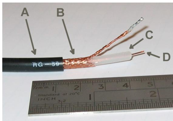
FIGURE 19 – Structure d'un câble coaxial : gaine extérieure en plastique (A), blindage en cuivre tressé (B), diélectrique (C) et conducteur central en cuivre (D) (*Source : Wikipedia*).
