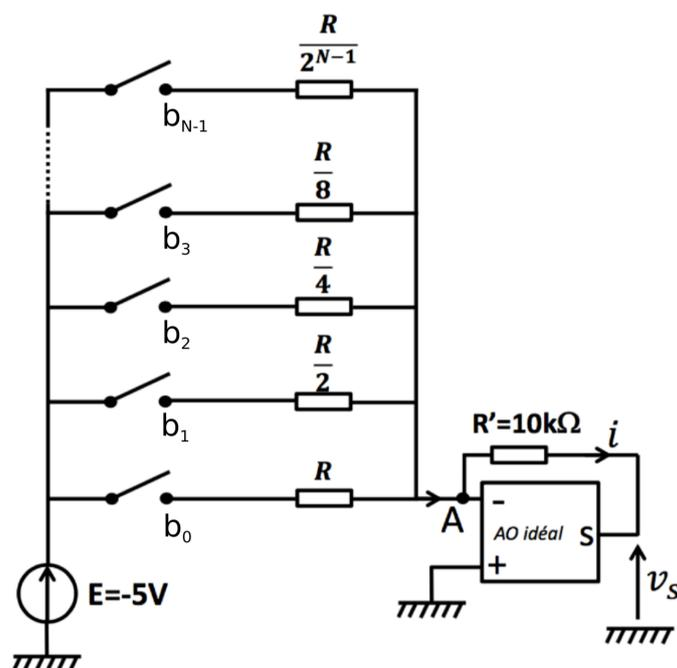
FIGURE 75 – Convertisseur numérique-analogique à réseau de pondération en tension.
