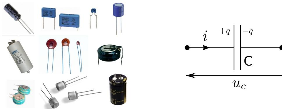
FIGURE 12 – *Gauche* : des condensateurs standard de valeurs diverses. *Droite* : le symbole du condensateur électrique.
