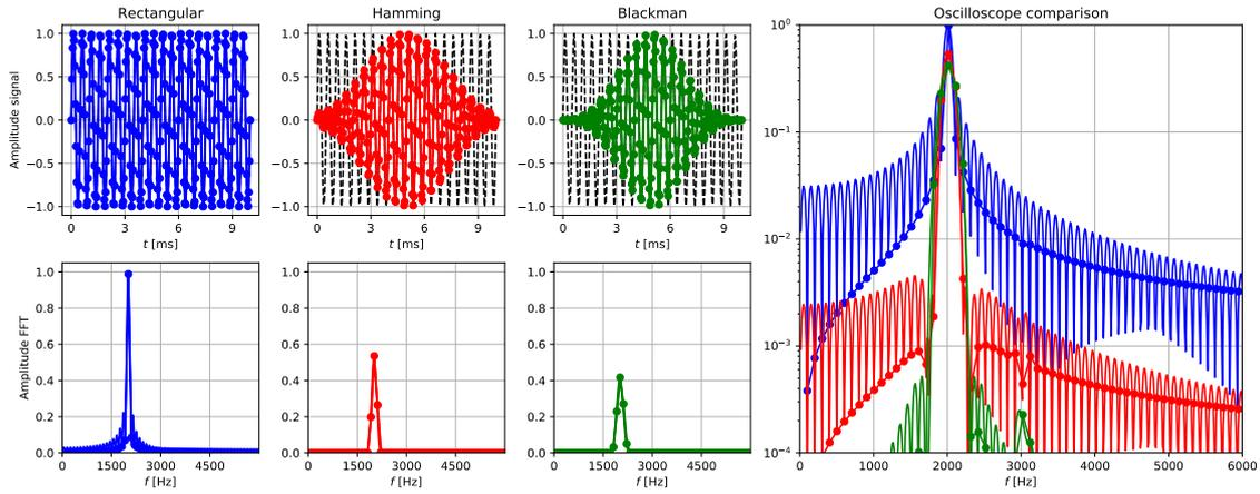
FIGURE 87 – A gauche le signal temporel  $s(t)$  avec  $f_1 = 2\text{ kHz}$ ,  $f_2 = 3\text{ kHz}$  et  $a = 0.0005$  échantillonné sur  $N = 256$  points et  $T_0 = 10\text{ ms}$ , pondéré par des fenêtres rectangulaire, Hamming et Blackmann, et les FFT correspondantes ( $\delta f = 100\text{ Hz}$ ). A droite, les traits pleins correspondent aux spectres théoriques (TF) calculés sur des signaux non échantillonnés, et les points aux spectres affichés à la résolution  $\delta f$  (FFT).
