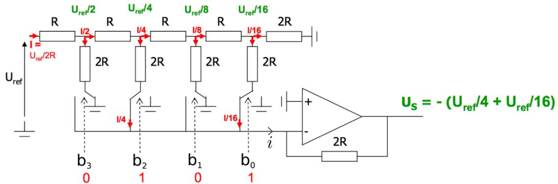
FIGURE 76 – Convertisseur numérique-analogique  $N = 4$  bits à réseau  $R - 2R$ .
