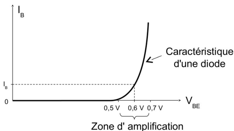
FIGURE 101 – Caractéristique  $I_B = f(V_{BE})$  à  $V_{CE}$  constant.
