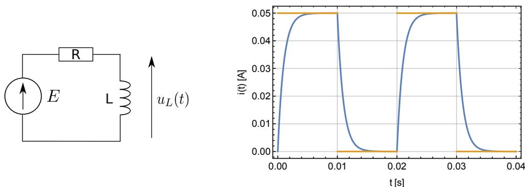
FIGURE 16 – *Gauche* : Circuit  $RL$  série alimenté par un générateur idéal de tension  $E(t)$  continue. Droite : réponse  $u_L(t)$  (bleu) du circuit pour un signal  $E(t)$  (jaune) carré compris entre  $+5\text{ V}$  et  $0\text{ V}$  avec  $R = 100\ \Omega$  et  $L = 0.1\text{ H}$  (donc  $\tau = 1\text{ ms}$ ).
