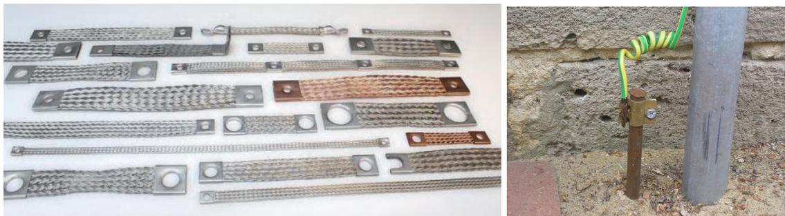
FIGURE 4 – *Gauche* : pour relier des carcasses et des circuits à la masse, la connexion doit être la plus courte possible, et avoir une surface de contact maximale, donc par sa forme en nappe, la tresse de masse est le conducteur le plus adapté à cette utilisation. *Droite* : piquet de terre en acier galvanisé (environ 60 cm de long) planté dans le sol au pied d'une maison (on remarque le fil normalisé rayé vert et jaune de mise à la terre).
