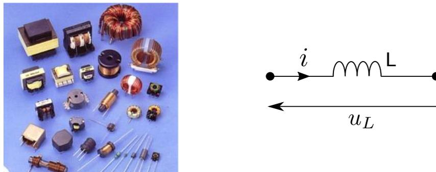
FIGURE 15 – *Gauche* : des bobines de conceptions diverses. *Droite* : le symbole de l'inductance électrique.
