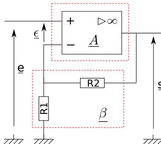
FIGURE 39 – Montage amplificateur non inverseur interprété comme système bouclé.
