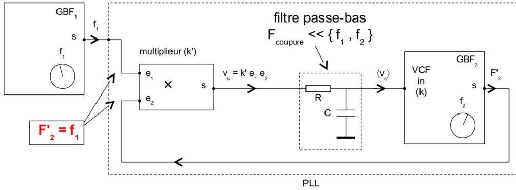
FIGURE 69 – Schéma bloc d'une boucle à verrouillage de phase analogique.
