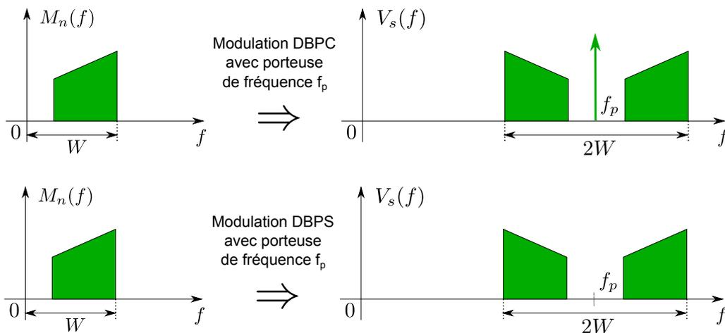
FIGURE 64 – Représentation fréquentielle de la modulation d'amplitude DBPC (haut) et DBPS (bas).
