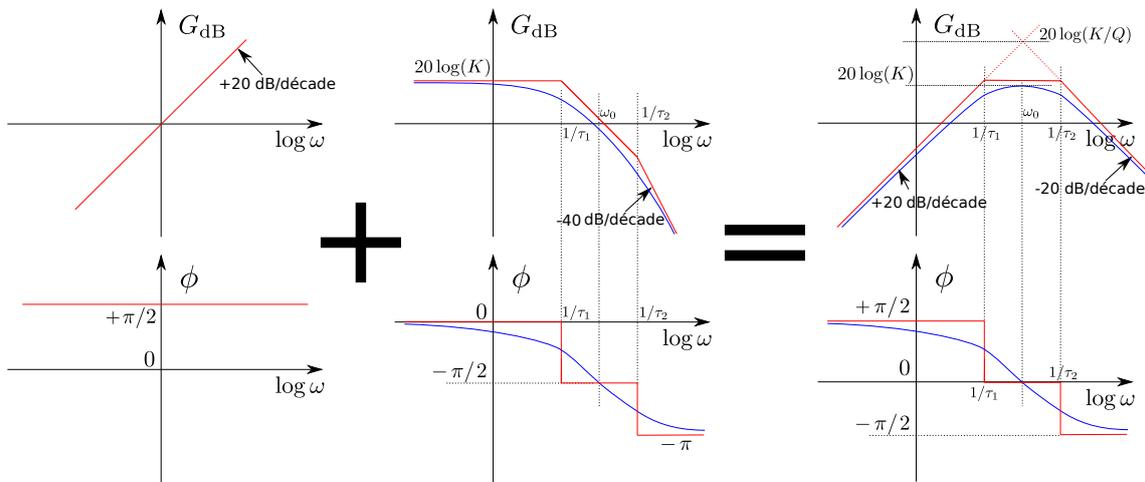
FIGURE 21 – Construction des diagrammes de Bode d'une fonction de transfert passe-bande du second ordre dans le cas  $\xi \geq 1 \Leftrightarrow Q \leq 1/2$ .
