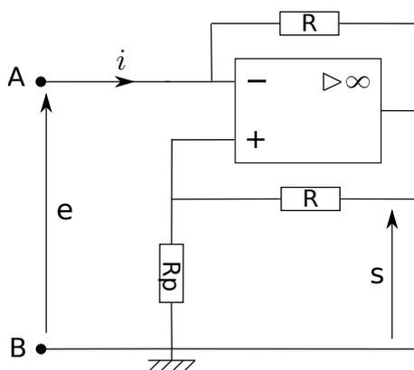
FIGURE 31 – Réalisation d'une résistance négative à l'aide d'un AO.
