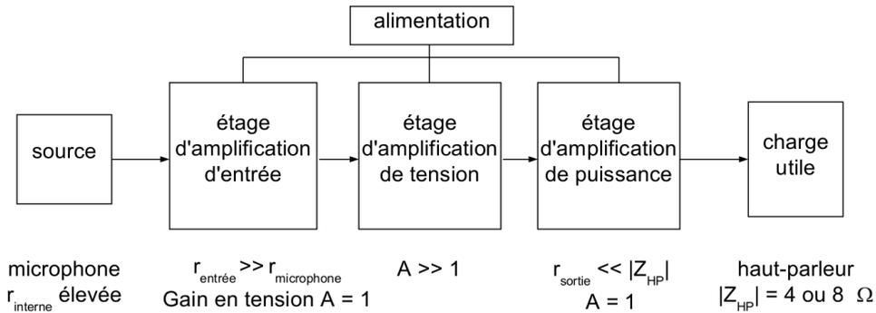
FIGURE 106 – Exemple typique d'un amplificateur de sonorisation. Les étages d'amplification d'entrée et de puissance sont ici des adaptateurs d'impédance.
