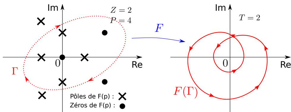
FIGURE 48 – Illustration du théorème de Cauchy : soit  $\Gamma$  un contour et  $F(p)$  une fonction du plan complexe.  $\Gamma$  entoure  $Z = 2$  zéros de  $F(p)$  et  $P = 4$  pôles de  $F(p)$ . Donc d'après le théorème de Cauchy la courbe  $F(\Gamma)$  entoure  $T = 2$  fois l'origine du plan complexe.
