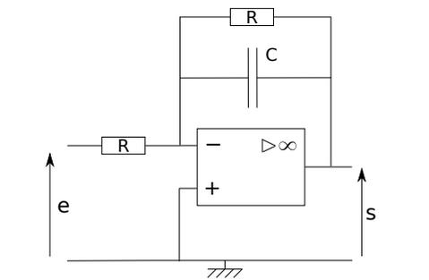
$\underline{H}(j\omega) = -\frac{1}{1 + jRC\omega}$ <p>fréquence de coupure <math>\omega_c = 1/RC</math></p>              | <p>Montage passe-haut (pseudo-dérivateur)</p>
