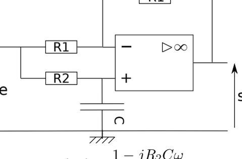
$\underline{H}(j\omega) = \frac{1 - jR_2C\omega}{1 + jR_2C\omega}$ <p><math>\forall \omega,  \underline{H}(j\omega)  = 1</math></p>     |
