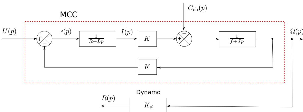
FIGURE 40 – Schéma bloc correspondant à la modélisation de la machine à courant continu et de la dynamo.
