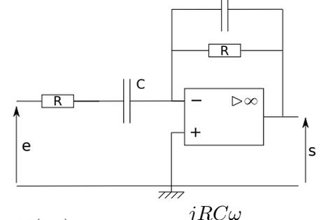
$\underline{H}(j\omega) = -\frac{jRC\omega}{1 + 2jRC\omega - (RC\omega)^2}$ <p>fréquence de résonance <math>\omega_0 \approx 1/RC</math></p> | <p>Montage passe-tout déphaseur</p>
