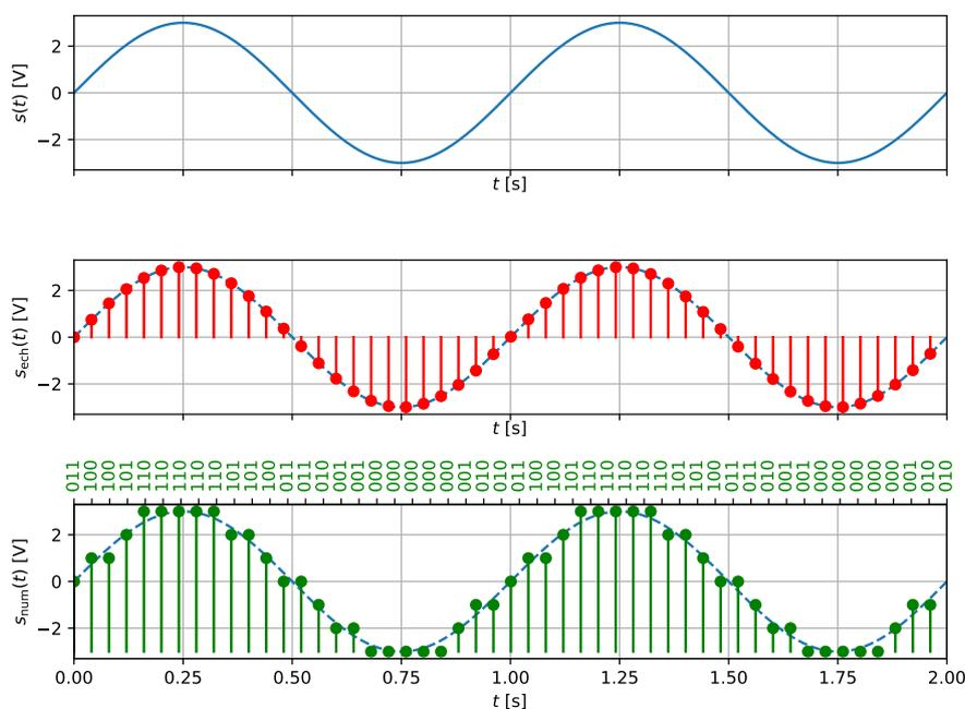
FIGURE 72 – Échantillonnage numérique d'un signal  $s(t)$  sur 8 niveaux multiples de 1 V : le signal peut être représenté par une suite de 0 et de 1.
