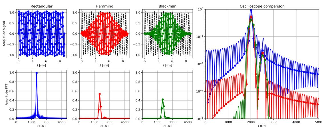
FIGURE 86 – A gauche le signal temporel  $s(t)$  avec  $f_1 = 2\text{ kHz}$ ,  $f_2 = 2.5\text{ kHz}$  et  $a = 0.05$  échantillonné sur  $N = 256$  points et  $T_0 = 10\text{ ms}$ , pondéré par des fenêtres rectangulaire, Hamming et Blackmann, et les FFT correspondantes ( $\delta f = 100\text{ Hz}$ ). A droite, les traits pleins correspondent aux spectres théoriques (TF) calculés sur des signaux non échantillonnés, et les points aux spectres affichés à la résolution  $\delta f$  (FFT).
