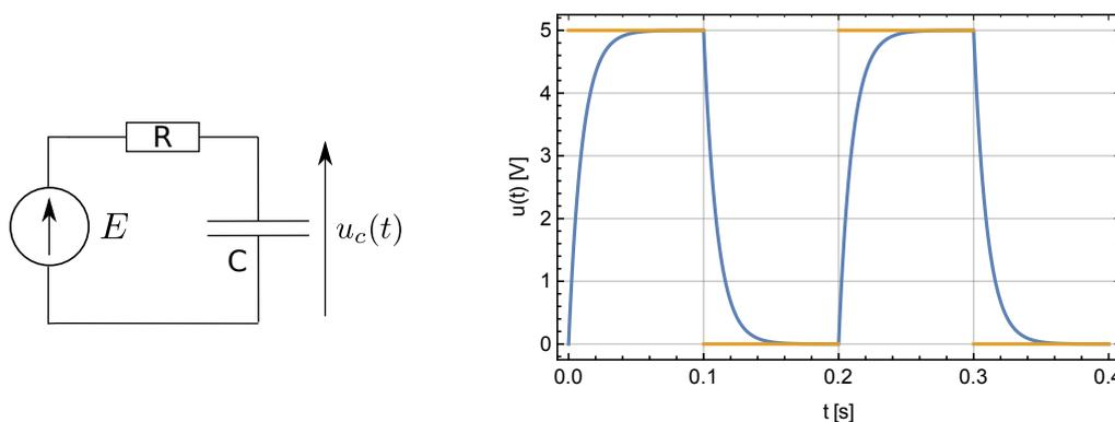
FIGURE 13 – *Gauche* : Circuit  $RC$  série alimenté par un générateur idéal de tension  $E(t)$  continue. *Droite* : réponse  $u_c(t)$  (bleu) du circuit pour un signal  $E(t)$  (jaune) carré compris entre +5 V et 0 V avec  $R = 10 \text{ k}\Omega$  et  $C = 1 \text{ }\mu\text{F}$  (donc  $\tau = 10 \text{ ms}$ ).
