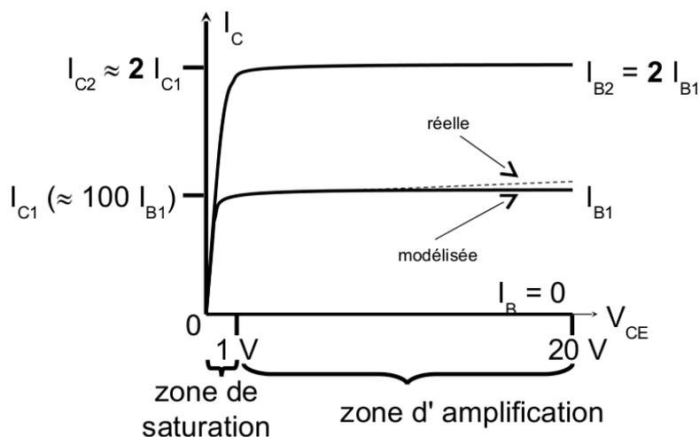
FIGURE 102 – Caractéristiques  $I_C = f(V_{CE})$  à  $I_B$  constant.
