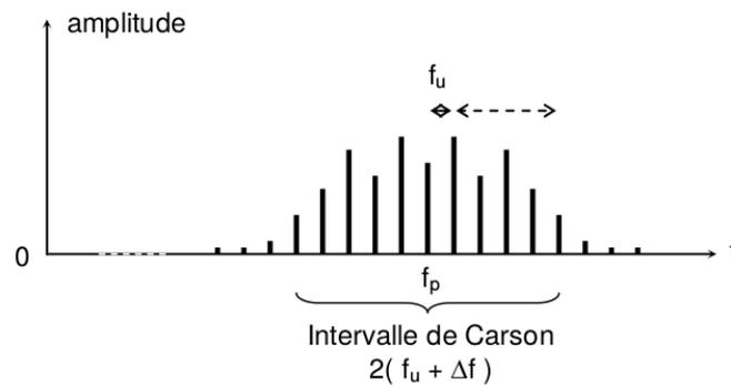
FIGURE 71 – Spectre d'un signal modulé en fréquence.
