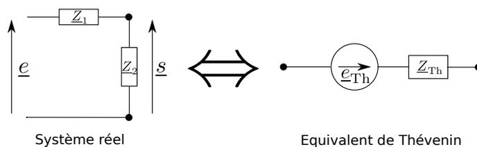
FIGURE 7 – Application du théorème de Thévenin à un pont diviseur de tension. Le générateur réel équivalent au pont diviseur de tension vu entre les deux points noirs est équivalent à un générateur de tension idéal de f.e.m.  $e_{Th}$  en série avec une impédance  $Z_{Th}$ .
