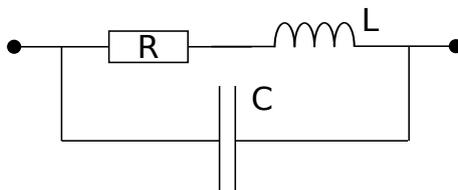
FIGURE 11 – Circuit électrique modélisant le comportement réel d'une résistance  $R$ . Le condensateur  $C$  modélise les effets capacitifs et l'inductance  $L$  les effets inductifs. Tout deux sont de faible valeur, et les résonances qu'elles provoquent se produisent pour des fréquences très élevées, hors du domaine d'utilisation de la résistance.
