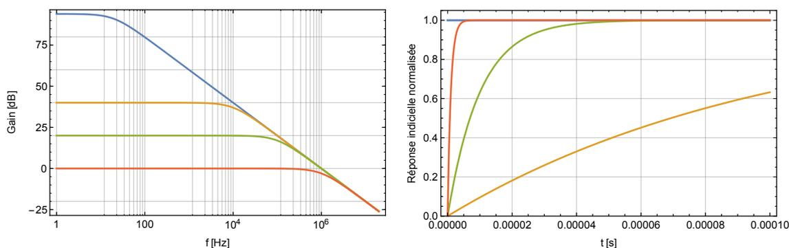
FIGURE 36 – Gauche : diagrammes de Bode en amplitude pour un montage amplificateur de gain  $G = 100$  (orange), 10 (vert), 1 (rouge) et pour l'AO  $\mu A741$  sans boucle de rétroaction (bleu). Droite : réponses temporelles indicielles normalisées en gain statique pour un montage amplificateur de gain  $G = 100$  (orange), 10 (vert), 1 (rouge), en bleu l'échelon de tension  $e(t)$  normalisé.
