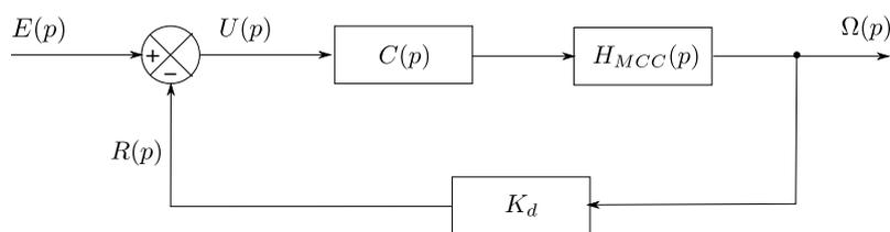
FIGURE 44 – Régulation de vitesse d'un moteur à courant continu avec élément correcteur.
