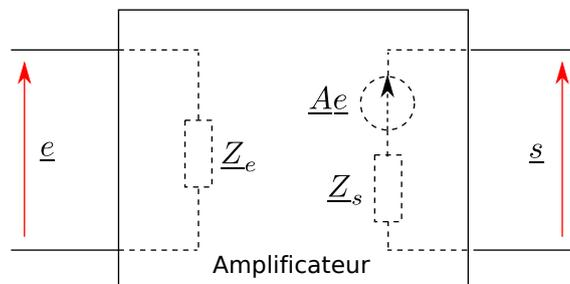
FIGURE 34 – Modèle général d'un quadripôle d'amplification.
