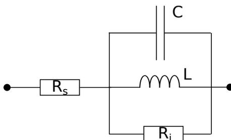
FIGURE 17 – Circuit électrique modélisant le comportement réel d'une inductance  $L$ . La résistance  $R_s$  modélise la résistance interne du fil de la bobine (correction la plus importante), la résistance  $R_i$  les pertes à haute fréquence dans le ferromagnétique, et le condensateur  $C$  les effets capacitifs apparaissant à haute fréquence.  $R_s$  et  $C$  sont de faible valeur mais  $R_i$  est une résistance très élevée.
