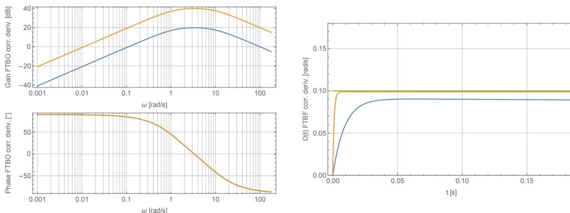
FIGURE 46 – *Gauche* : diagrammes de Bode de la fonction de transfert  $H_{FTBO}^c(p)$  avec correction dérivative pour  $K_c = 1$  (bleu), 10 (jaune). *Droite* : réponse temporelle de la boucle fermée associée à la fonction de transfert  $H_{FTBF}^c(p)$  avec correction dérivative pour  $K_d = 10$  et différentes valeurs  $K_c = 1$  (bleu), 10 (jaune) pour un échelon de commande (vert) : la précision et la rapidité augmentent avec  $K_c$  et les oscillations disparaissent.
