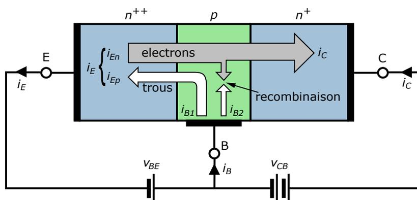
FIGURE 99 – Principe de fonctionnement du transistor npn (Source : Wikipedia).
