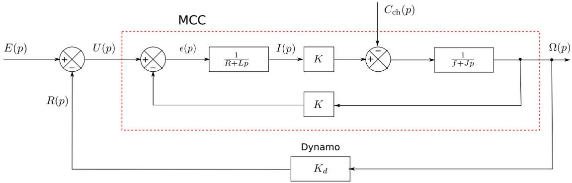
FIGURE 43 – Régulation de vitesse d'un moteur à courant continu.
