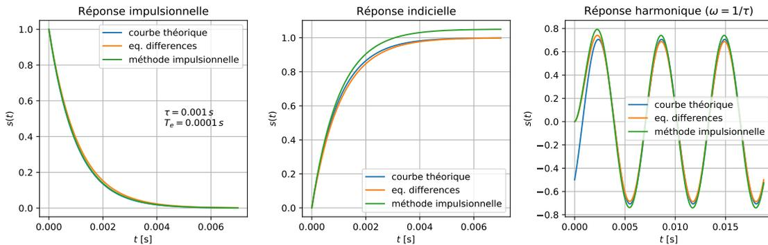
FIGURE 89 – Réponses impulsionnelles, indicielles et harmoniques d'un filtre numérique passe-bas réalisé selon deux méthodes, avec  $\tau = 1$  ms et  $T_e = \tau/10$ .
