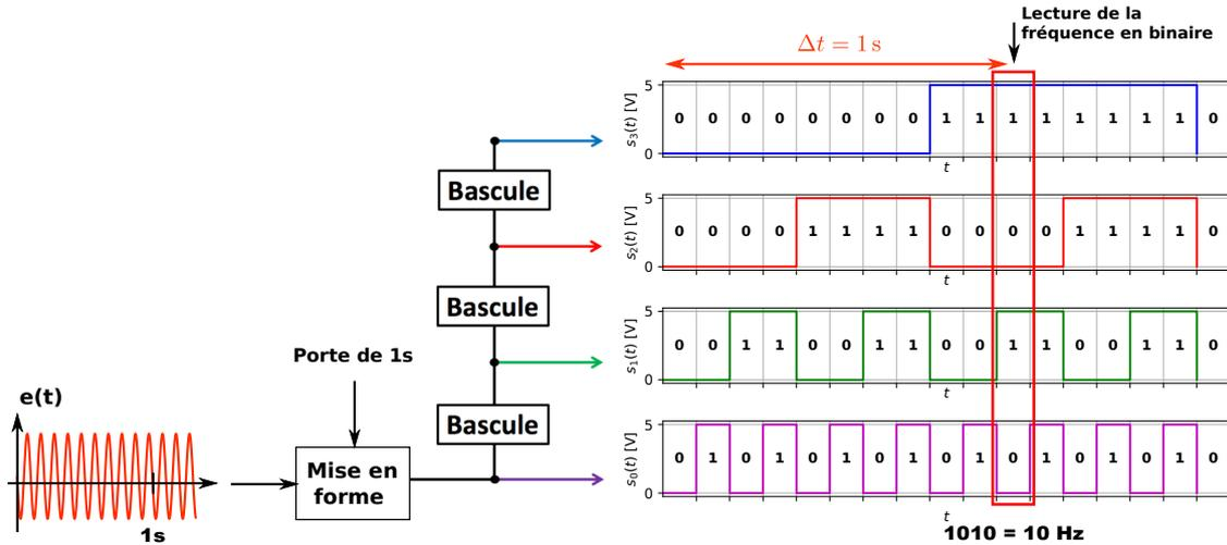
FIGURE 74 – Principe du compteur numérique, utilisé en fréquencemètre numérique avec  $N = 4$  bits.
