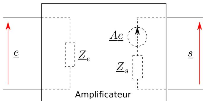
FIGURE 105 – Modèle équivalent d'un amplificateur. Suivant la technologie de l'amplificateur, une relation différente lie  $e(t)$  à  $s(t)$  mais elle est souvent du type  $s(t) = A \times e(t)$  avec  $A$  une constante.
