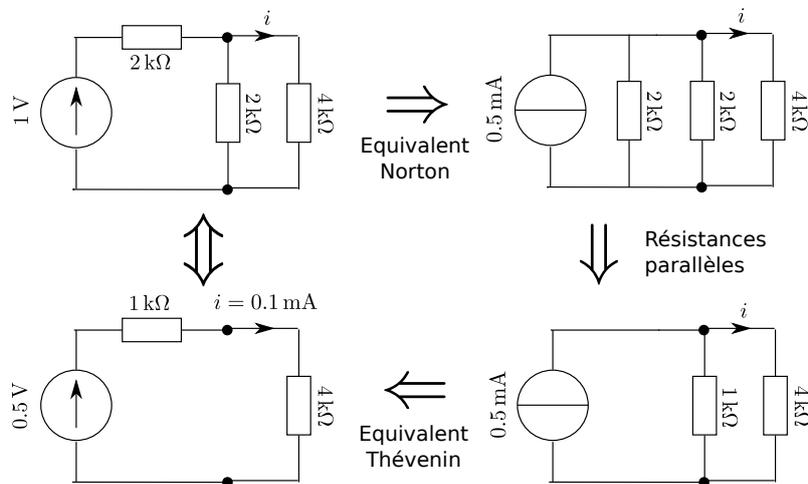
FIGURE 8 – Application du théorème de Thévenin à un pont diviseur de tension alimentant une résistance de charge de  $4\text{ k}\Omega$ , en utilisant les équivalents générateurs tension/courant [15].
