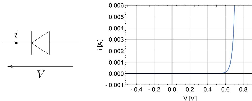
FIGURE 94 – Représentation symbolique et caractéristique d'une diode à jonction pn.
