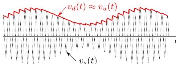
FIGURE 67 – Effet de la détection de crête sur une porteuse modulée par un signal sinusoïdal de période  $T_u$ .
