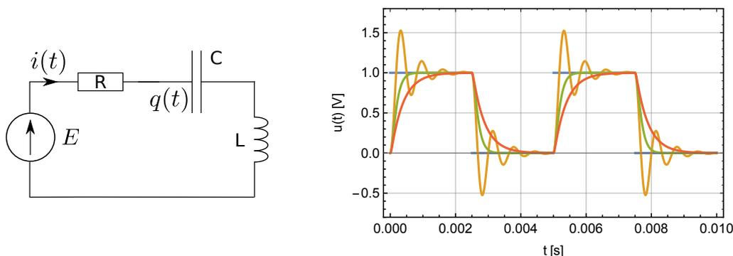
FIGURE 18 – *Gauche* : Circuit  $RLC$  série alimenté par un générateur idéal de tension  $E(t)$  continue. *Droite* : tension aux bornes du condensateur  $u_c(t)$  pour un signal  $E(t)$  (bleu) carré compris entre  $+5\text{ V}$  et  $0\text{ V}$  avec  $\omega_0 = 10^4\text{ rad/s}$  et  $Q = 2.5$  (jaune),  $Q = 0.5$  (vert) et  $Q = 0.25$  (rouge).
