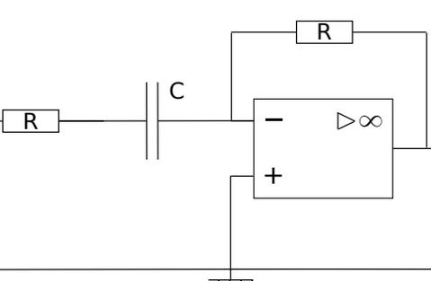
$\underline{H}(j\omega) = -\frac{jRC\omega}{1 + jRC\omega}$ <p>fréquence de coupure <math>\omega_c = 1/RC</math></p>          |
