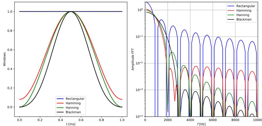
FIGURE 83 – Différentes fonctions de fenêtrage  $W(t)$  (gauche) et les transformées de Fourier correspondantes (droite).
