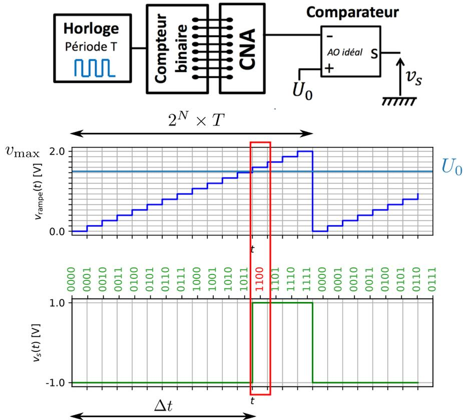
FIGURE 78 – Convertisseur analogique-numérique réalisé à partir d’un convertisseur simple rampe. Dans cette illustration  $N = 4$  bits et le calibre est  $v_{\max} = 2$  V. Pour une tension à convertir  $U_0 = 1.5$  V, le CAN renvoie 1100 ce qui correspond à  $U_{\text{mes}} = 1.6$  V.
