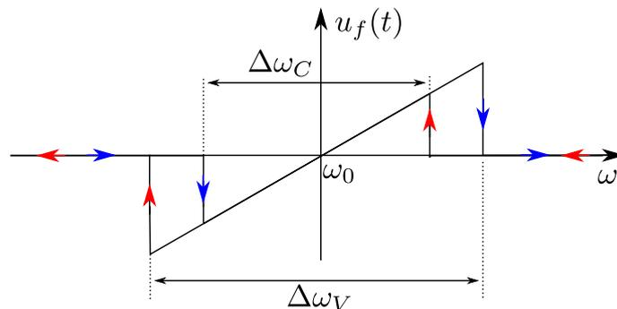
FIGURE 70 – Plages de capture et de verrouillage de la boucle à verrouillage de phase. Les flèches représentent les deux chemins par valeur de pulsation ascendante ou descendante qui illustrent la capture puis le verrouillage de la boucle.
