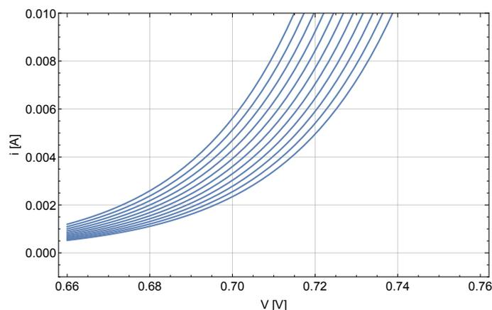
FIGURE 96 – Caractéristiques d’une jonction pn pour des températures  $T$  allant de de 300 K à 310 K (de gauche à droite). A un courant donné  $i$ , l’espacement entre les caractéristiques est quasiment linéaire avec la température, sur une plage assez grande.
