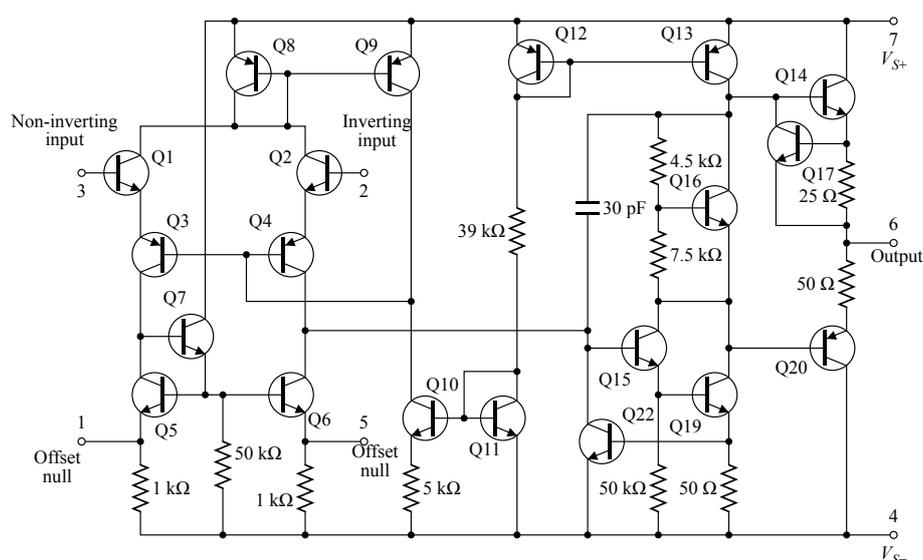
FIGURE 24 – Structure interne d'un amplificateur opérationnel 741 (source : adapté de Wikipedia).
