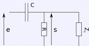
$$\underline{H}_2(j\omega) = \frac{s}{e} = \frac{jRC\omega}{R + Z_c + \frac{jRZ_cC\omega}{R+Z_c}} \neq \underline{H}_1(j\omega)$$
