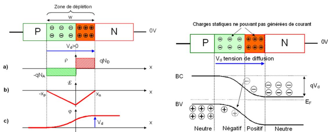
FIGURE 92 – Jonction pn à l'équilibre. *Gauche* : a) représentation des charges d'espace  $\rho$  en fonction de la densité de donneurs  $N_D$  et d'accepteurs  $N_A$ , b) le champ électrique c) le potentiel électrostatique. *Droite* : diagramme d'énergie d'une jonction pn représentant la difficulté pour les porteurs de charge de traverser la jonction du fait du potentiel électrostatique et des recombinaisons. (Source : <http://www.optique-ingenieur.org>)
