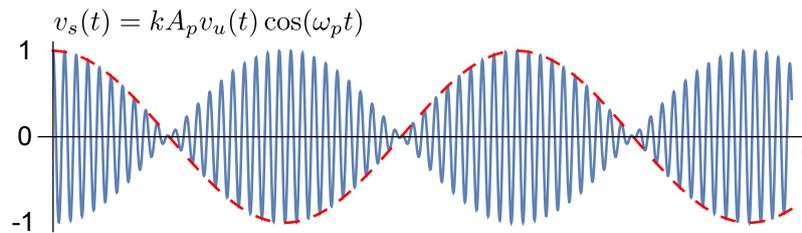
FIGURE 65 – Allure du signal émis en modulation d'amplitude à porteuse supprimée.
