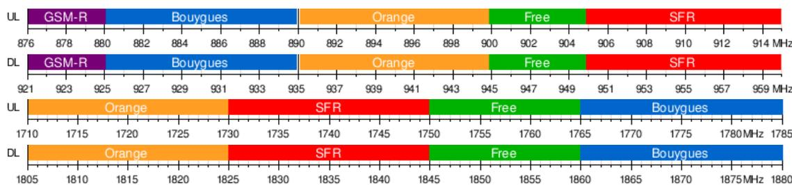
FIGURE 60 – Attribution des canaux de fréquence GSM en France en 2016 : les différents canaux sont répartis entre les 4 opérateurs téléphoniques et SNCF-Réseau (GSM-R), sur deux bandes centrées sur 900 MHz et 1800 MHz, elles-mêmes coupées en deux pour la réception (DL) et l'émission (UL) d'information (*source : Wikipedia*).
