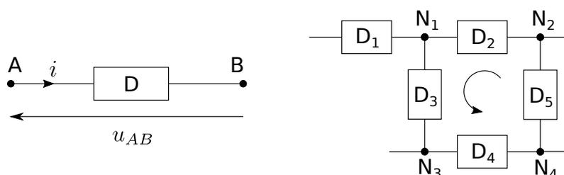
FIGURE 1 – *Gauche* : schéma électrique d'un dipôle parcouru par un courant  $i$  et soumis à une tension  $u_{AB}$ . *Droite* : schéma d'un circuit électrique constitué de dipôles.
