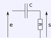
$$\underline{H}_1(j\omega) = \frac{s}{e} = \frac{jRC\omega}{1 + jRC\omega}$$
