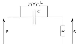
$\underline{H}(j\omega) = \frac{1 - LC\omega^2}{1 + j\frac{L}{R}\omega - LC\omega^2}$ |
