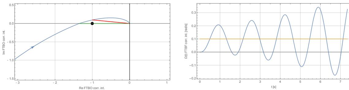
FIGURE 53 – *Gauche* : lieu de Nyquist de la fonction de transfert  $H_{FTBO}(j\omega)$  pour une machine à courant continu asservie en vitesse de rotation avec un correcteur intégral telle que le système dépasse le point critique  $-1$  ( $K_c = 1.5$ ). *Droite* : réponse temporelle (bleu) à un échelon de tension (jaune) du système devenu instable par une trop grande valeur du correcteur intégral.
