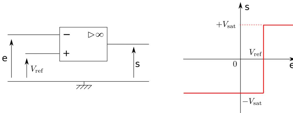
FIGURE 32 – *Gauche* : montage comparateur simple de tension non inverseur. *Droite* : caractéristique du comparateur simple non inverseur.
