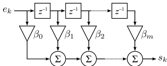
FIGURE 91 – Structure directe d'un filtre non récursif (*source : adapté de Wikipedia*).
