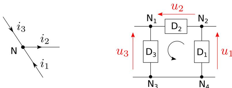
FIGURE 5 – *Gauche* : la loi des nœuds appliquée au nœud  $N$  donne  $i_1 + i_3 - i_2 = 0$ . *Droite* : la loi des mailles appliquée à la maille orientée  $N_1N_3N_4N_2$  donne  $u_1 + u_2 - u_3 = 0$ .
