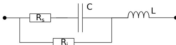
FIGURE 14 – Circuit électrique modélisant le comportement réel d'un condensateur  $C$ . La résistance  $R_i$  modélise les courants de fuite, la résistance  $R_s$  les pertes à haute fréquence dans le diélectrique, et l'inductance  $L$  les effets inductifs.  $R_s$  et  $L$  sont de faible valeur mais  $R_i$  est une résistance très élevée.
