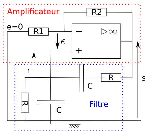
FIGURE 55 – Oscillateur à pont de Wien.
