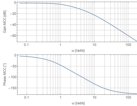
FIGURE 41 – Fonction de transfert  $H_{MCC}(p)$  du moteur à courant continu étudié.
