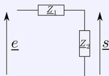
Soient deux impédances  $Z_1$  et  $Z_2$  associées en série et soumises à une tension  $e$ . La tension  $s$  aux bornes de  $Z_2$  est alors :
