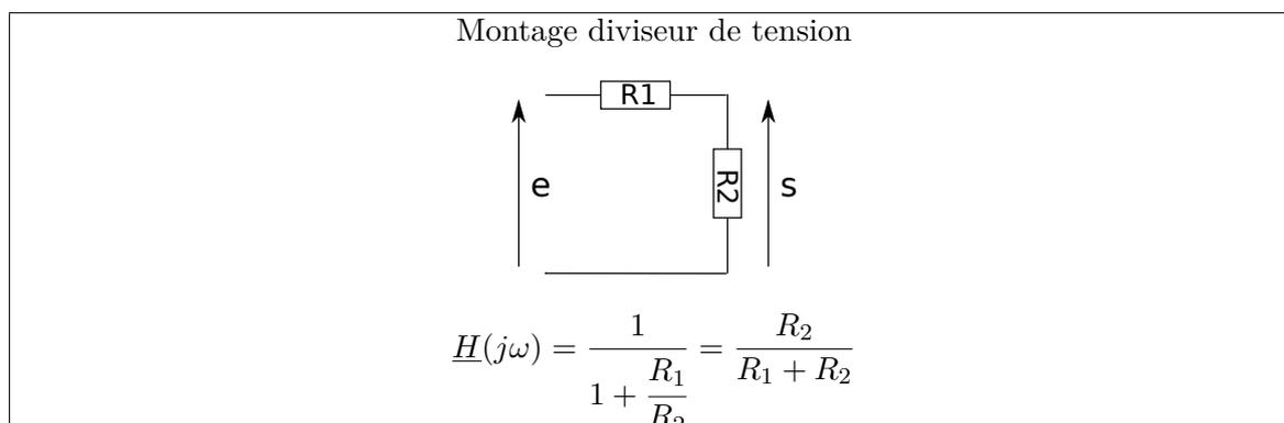
21. Astuce pour trivialisier le calcul des fonctions de transfert : connaître par cœur la formule et le schéma du diviseur de tension car la fonction de transfert se calcule alors rapidement avec  $\underline{H} = \frac{u_1}{u_{tot}} = \frac{Z_{eq1}}{Z_{tot}}$ .
