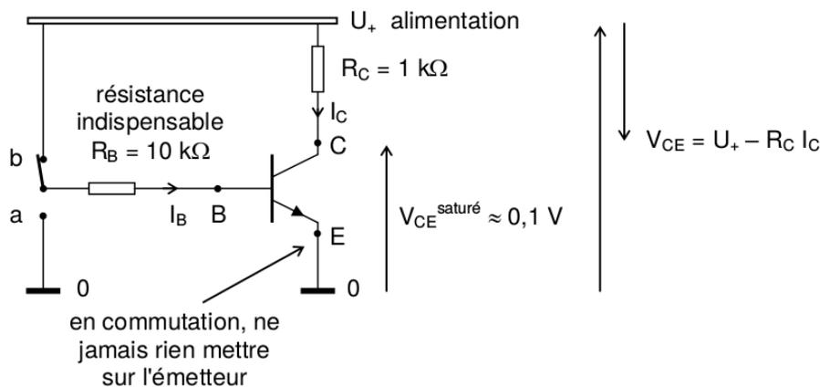
FIGURE 112 – Illustration du fonctionnement du transistor en commutation. En général il n’y a pas d’interrupteur sur l’entrée, mais dans notre cas il permet de discuter du fonctionnement du montage.
