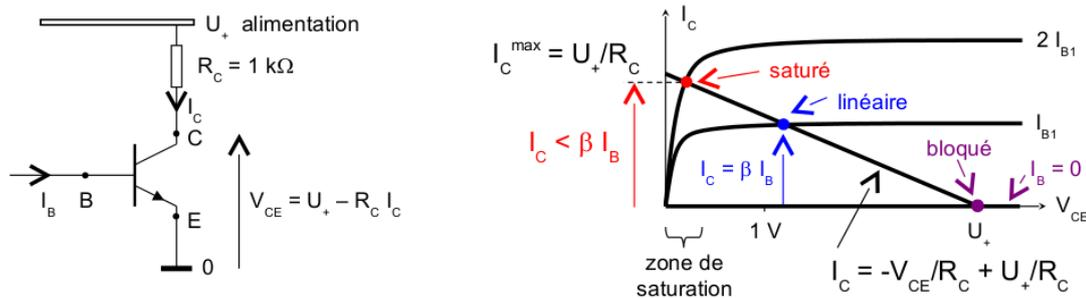
FIGURE 103 – Les trois régimes de fonctionnement du transistor. Pour les caractériser, ici l'émetteur est placé à la masse et le point de fonctionnement est défini par une charge  $R_C$  branchée au collecteur, de caractéristique  $I_C = U_+/R_C - V_{CE}/R_C$ . On observe que selon le courant de base  $I_B$  injecté le transistor peut fonctionner selon trois régimes : bloqué ( $I_B = 0$ ), linéaire ( $I_B = I_C/\beta$ ) et saturé ( $I_B > I_C/\beta$ ).
