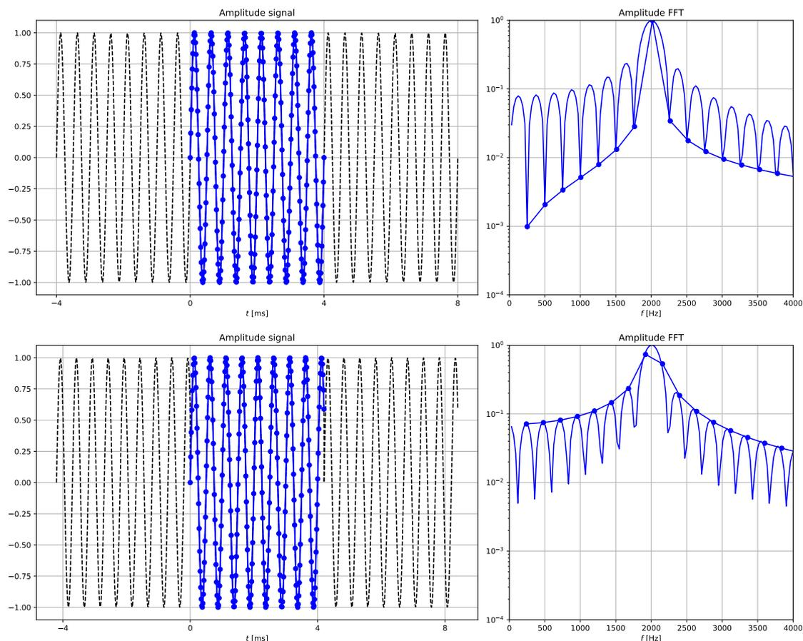
FIGURE 82 – *Haut* : A gauche le signal temporel  $s(t)$  sinusoïdal de fréquence 2 kHz d’amplitude 1 V échantillonné sur  $N = 256$  points et  $T_0 = 4$  ms, pondéré une fenêtre rectangulaire, et la FFT correspondante ( $\delta f = 250$  Hz). A droite, les traits pleins correspondent aux spectres théoriques (TF) calculés sur des signaux non échantillonnés, et les points aux spectres affichés à la résolution  $\delta f$  (FFT). *Bas* : idem mais  $T_0 = 4.2$  ms ( $\delta f = 238$  Hz).
