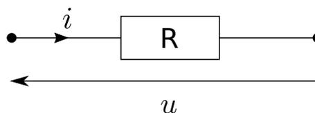
FIGURE 9 – *Gauche* : des résistances standard de valeurs diverses. *Droite* : le symbole de la résistance électrique.
