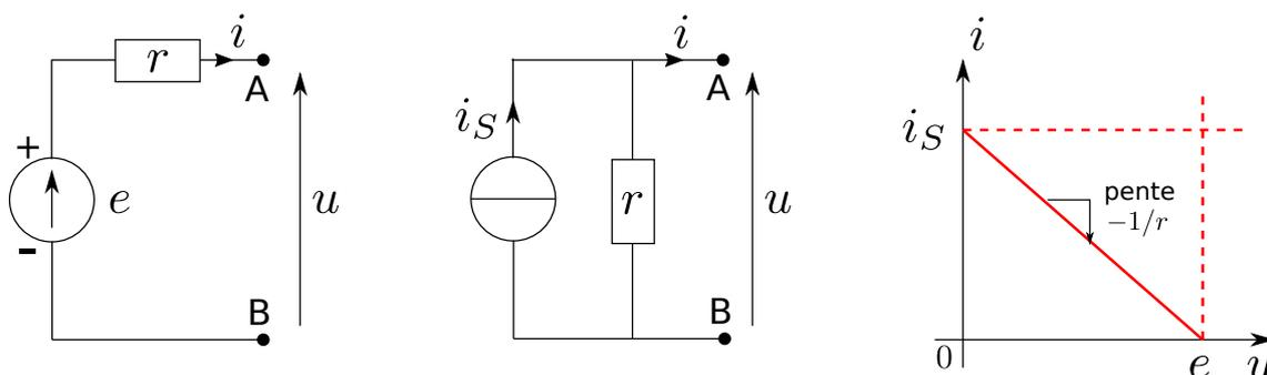
FIGURE 2 – Schémas électriques d'une source de tension réelle (gauche) et d'une source de courant réelle (milieu). Les caractéristiques des sources de tension et de courant idéales (en trait pointillés) et réelles (en trait plein) sont représentées à droite.
