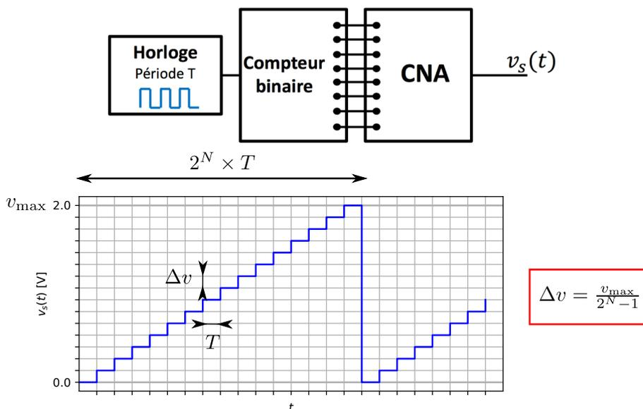
FIGURE 77 – Principe du convertisseur simple rampe.
