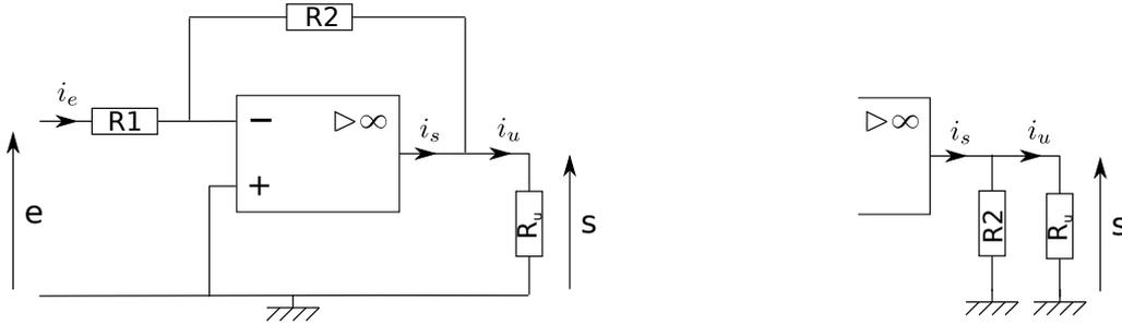
FIGURE 35 – *Gauche* : Étude du montage amplificateur inverseur en charge. *Droite* : détail de la sortie de l'AO.
