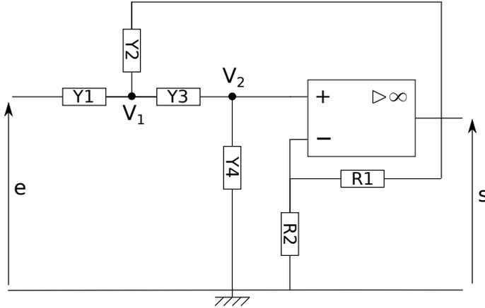
FIGURE 33 – Cellule de Sallen et Key à gain variable.
