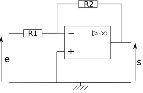
$\underline{H}(j\omega) = -\frac{R_2}{R_1}$                                                                                        | <p>Montage amplificateur non inverseur</p>
