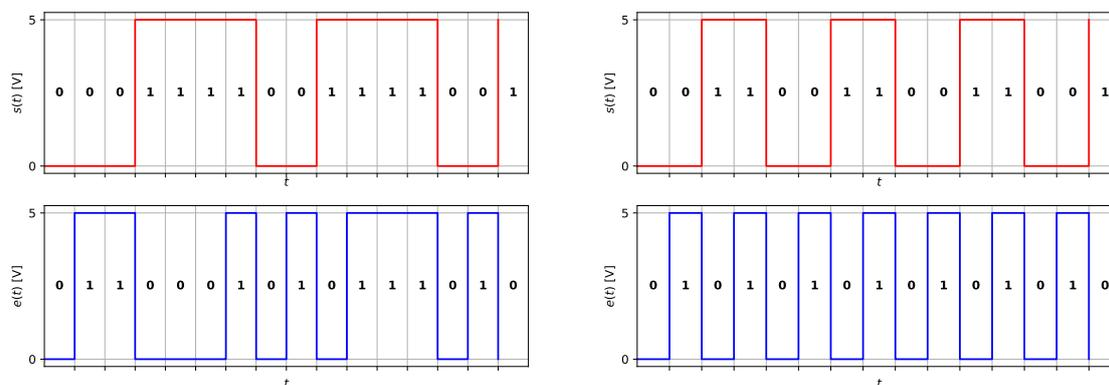
FIGURE 73 – *Gauche* : fonctionnement d'une bascule logique sur front descendant. *Droite* : application au diviseur de fréquence.
