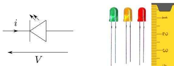
FIGURE 97 – *Gauche* : représentation symbolique des LEDs. *Droite* : LEDs de différentes couleurs.
