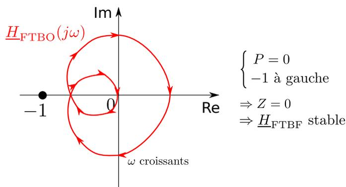
FIGURE 50 – Illustration du critère du revers : si  $\underline{H}_{FTBO}(p)$  est stable et que son contour passe à droite du point critique  $-1$  dans le sens des  $\omega$  croissantes, alors on sait que bouclé ce système sera stable.
