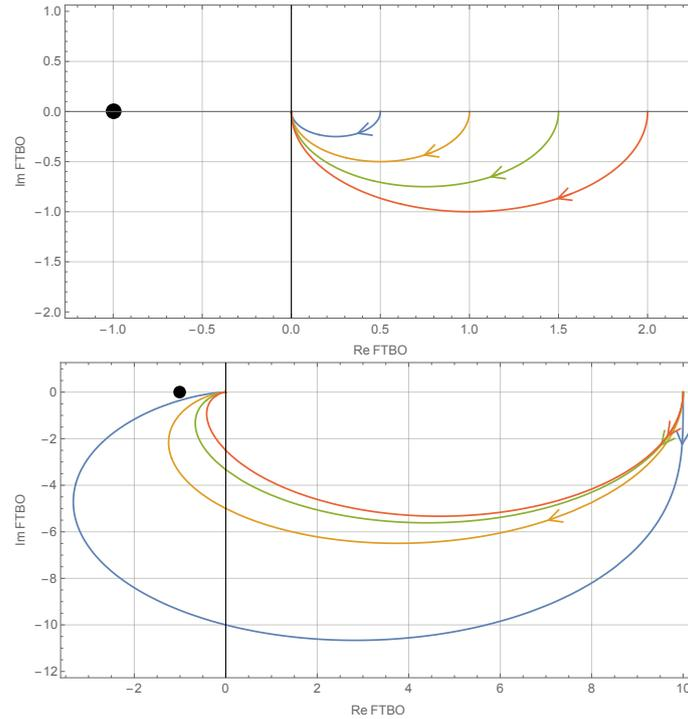
FIGURE 51 – *Haut* : lieu de Nyquist de la fonction de transfert d'ordre 1  $H_{FTBO}(j\omega) = K/(1+j\omega\tau)$  pour différentes valeurs de  $K$ . *Bas* : lieu de Nyquist de la fonction de transfert d'ordre 2  $H_{FTBO}(j\omega) = K/(1 + 2\xi j\omega/\omega_0 - \omega^2/\omega_0^2)$  pour différentes valeurs de  $\xi$ .
