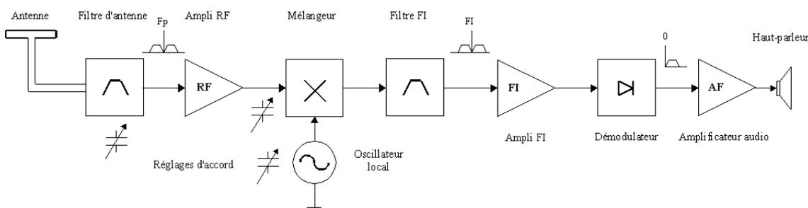
FIGURE 61 – Chaîne de réception superhétérodyne dans le cas de la radio (*source : Wikipedia*)
