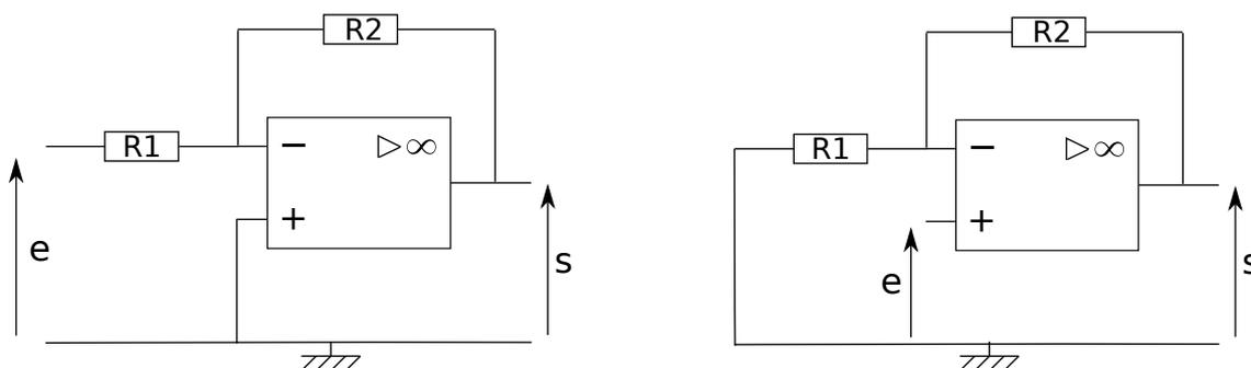
FIGURE 28 – Gauche : montage amplificateur inverseur. Droite : montage amplificateur non inverseur.
