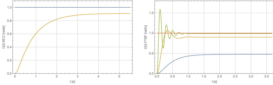
FIGURE 42 – *Gauche* : réponse temporelle associée à la fonction de transfert  $H_{MCC}(p)$  (jaune) pour un échelon de commande (bleu) : une erreur statique est présente. *Droite* : réponse temporelle de la boucle fermée associée à la fonction de transfert  $H_{FTBF}(p)$  pour différentes valeurs  $K_d = 1$  (bleu), 10 (jaune), 100 (vert) pour un échelon de commande (rouge) : la précision et la rapidité augmentent avec  $K_d$  mais des oscillations apparaissent.
