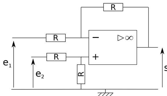
FIGURE 30 – Montage soustracteur.
