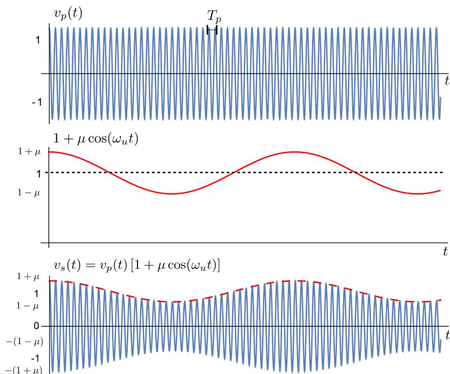
FIGURE 62 – Représentation de la modulation d’amplitude d’une porteuse sinusoïdale par un signal sinusoïdal additionné d’un offset.
