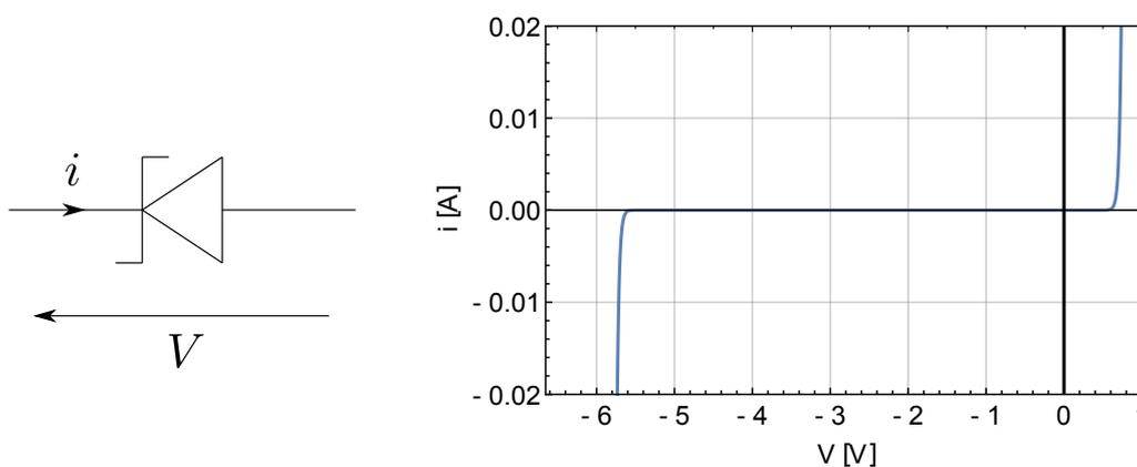
FIGURE 95 – Représentation symbolique et caractéristique d'une diode Zener.
