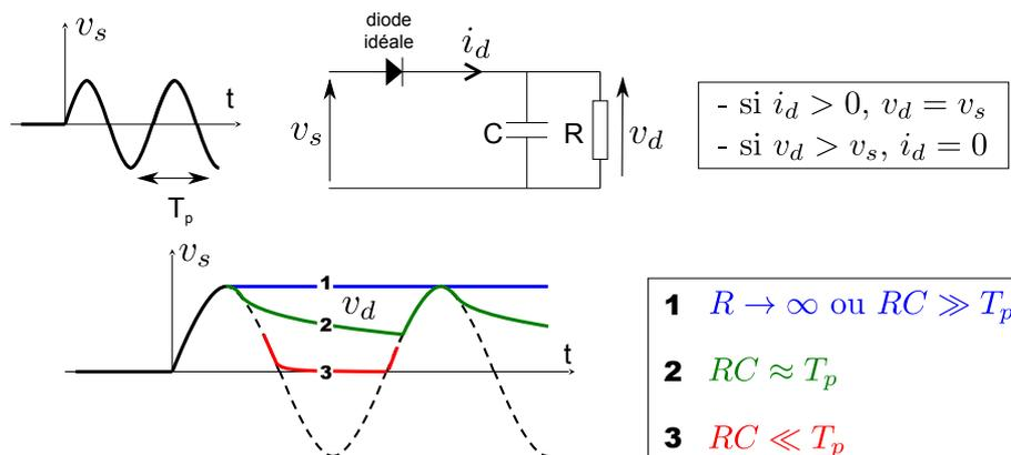
FIGURE 66 – Principe de la détection de crête.
