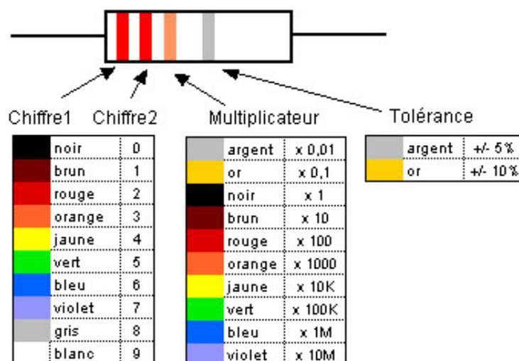
FIGURE 10 – La valeur de la résistance et sa tolérance sont inscrites sur le composant à l'aide d'un code couleur.
