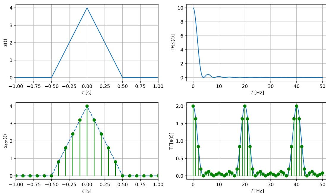
FIGURE 80 – *Haut* : signal triangulaire et sa transformée de Fourier. *Bas* : signal triangulaire numérisé à une fréquence d'échantillonnage  $f_e = 20$  Hz, sa transformée de Fourier (trait plein bleu) et sa TFD (points verts).
