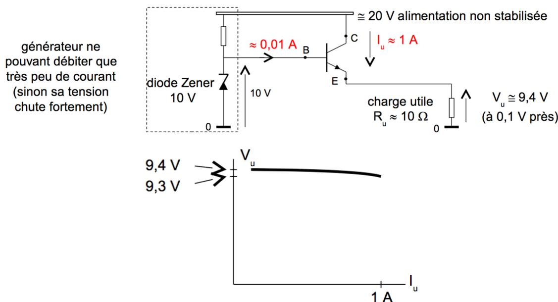
FIGURE 108 – Principe d'une alimentation stabilisée à l'aide d'un suiveur de puissance.
