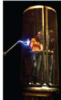
C'est ce qui explique pourquoi on est (à peu près) protégé à l'intérieur d'une voiture lors d'un orage, même si l'éclair tombe sur la voiture ! Ce concept est souvent utilisé pour protéger des appareils électriques (boîtier d'ordinateur, grille du micro-ondes devant la porte, etc.).
