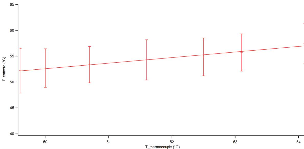
Les problèmes de la caméra thermique : Seule l'émissivité tabulée de la plaque centrale est correcte, les autres ne le sont plus et permettent difficilement de remonter à des valeurs. Sur la plaque centrale la température varie pas mal. On peut remarquer que si on peut bien tracer une droite, il y a une ordonnée à l'origine non nul. Peut-être aurait-il fallu relever sur le logiciel la température à côté du thermocouple, au lieu de moyenne sur l'ensemble de la plaque.
