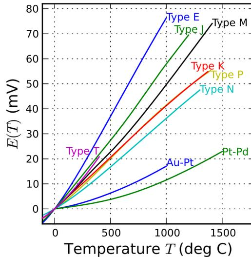
Les différences type de thermocouples auront des sensibilité, mais aussi des gammes différentes. Un thermocouple de type T est utilisé pour le point triple de l'azote car la température de ce point triple est hors de la gamme de température atteinte par les
