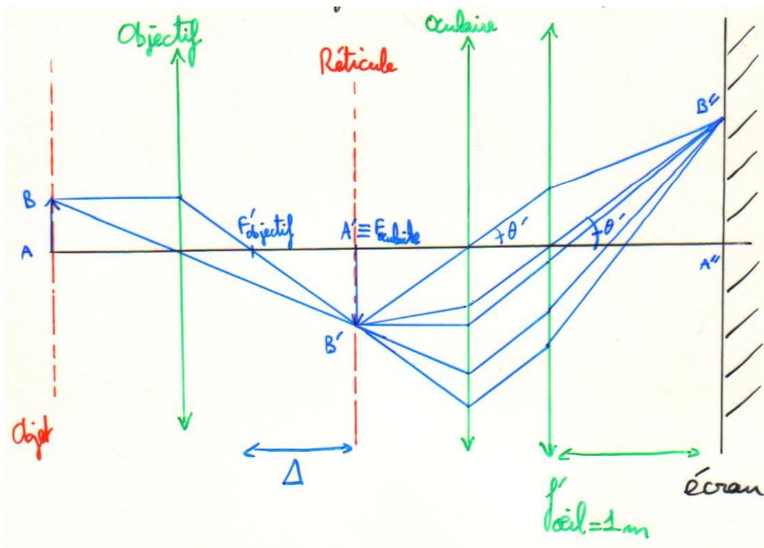
De même que pour l'oculaire, la relation naturelle « entrée-sortie » du microscope est la puissance.
