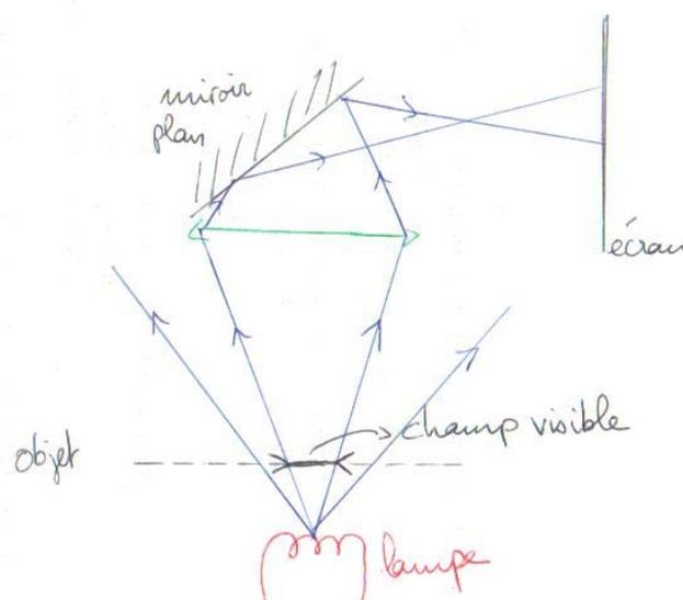
Il nous faut donc un système permettant de conjuguer la source et l'objectif. De plus, il faut faire en sorte que ces rayons passent au centre de l'objectif.
