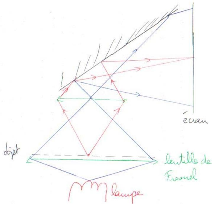
C'est alors le condenseur qui limite le champ, et l'objectif qui limite l'ouverture. Après ajout de la lentille de Fresnel, l'image formée est de bonne qualité, l'éclairage est uniforme, et la résolution suffisante à l'usage que l'on souhaite en faire.
