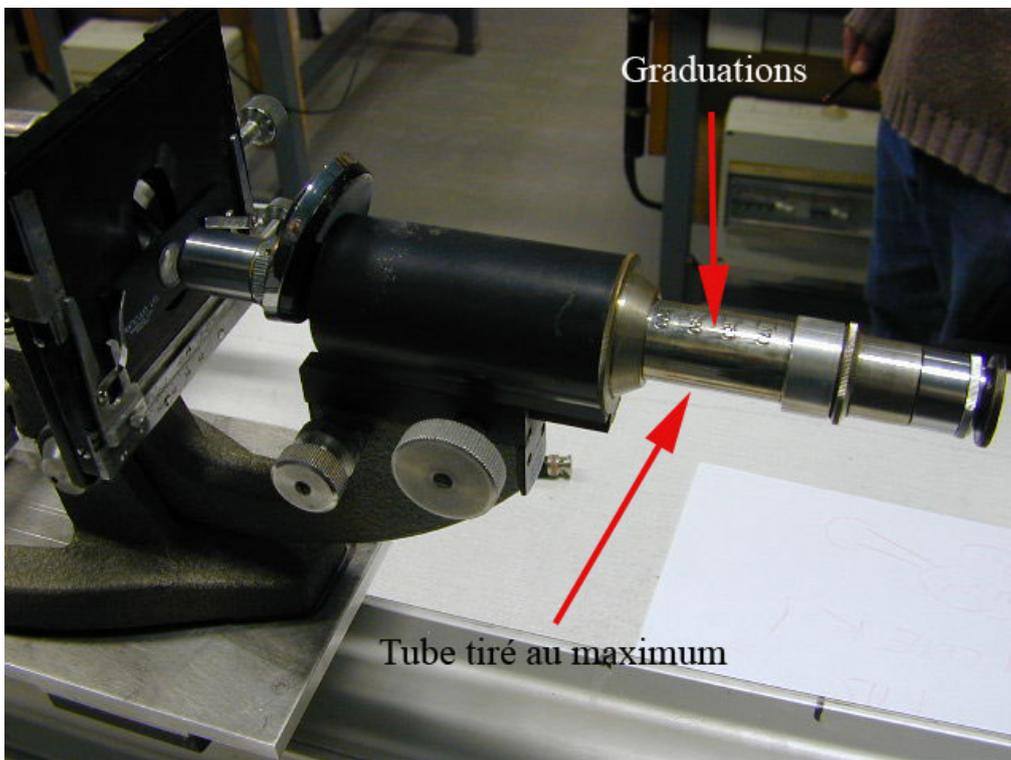
L'image intermédiaire se trouvant dans le plan focal objet de l'oculaire, le grandissement transverse de l'objectif s'écrit (pour les notations : cf. schéma plus bas) :
