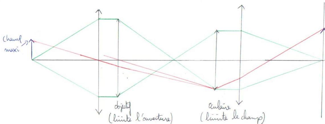
On voit sur ce schéma que c'est l'objectif qui limite l'ouverture (cf. définition du diaphragme d'ouverture dans la partie microscope), et que l'oculaire limite le champ.
