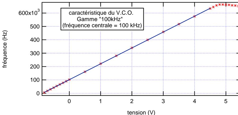
Pour des tensions d'entrée du V.C.O. inférieures à -0.9V ou supérieures à 4.7V, le signal se distord et le V.C.O. ne répond plus de façon satisfaisante. En revanche, entre ces deux valeurs de tension d'entrée, le composant réagit suivant l'équation
