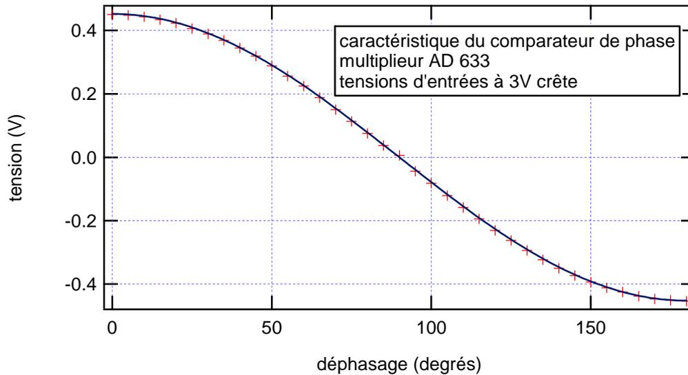
Pour réaliser cette expérience, on a utilisé deux générateurs 33220 synchronisables entre lesquels on peut contrôler précisément le déphasage.
