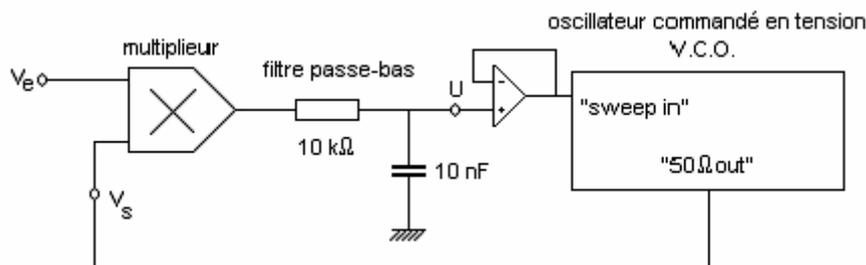
Entre le comparateur de phase et le V.C.O., on a placé un suiveur car l'impédance d'entrée du V.C.O. vaut 10kΩ, ce qui entraînerait une modification de la fréquence de coupure et du gain du filtre si ce circuit n'était pas placé.
