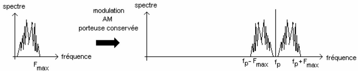
Pour démoduler un tel signal, on peut envisager de réaliser une détection cohérente. Pour cela, on multiplie le signal modulé par un signal sinusoïdal à la même fréquence que la porteuse, déphasé de  $\varphi$  par rapport à la porteuse de démodulation, ce qui nous donne un signal  $s_i(t)$  (le facteur  $1/10$  représente le gain du multiplieur).
