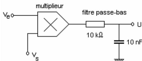
Le composant utilisé est un AD633, de gain 1/10, dont le schéma de brochage est rappelé en annexe à la fin de ce document. Il donnera des résultats satisfaisants jusqu'à quelques centaines de kHz. L'ensemble multiplieur et filtre passe-bas est disponible directement sur la maquette 336-2 (cette maquette comporte même deux ensembles de ce type).
