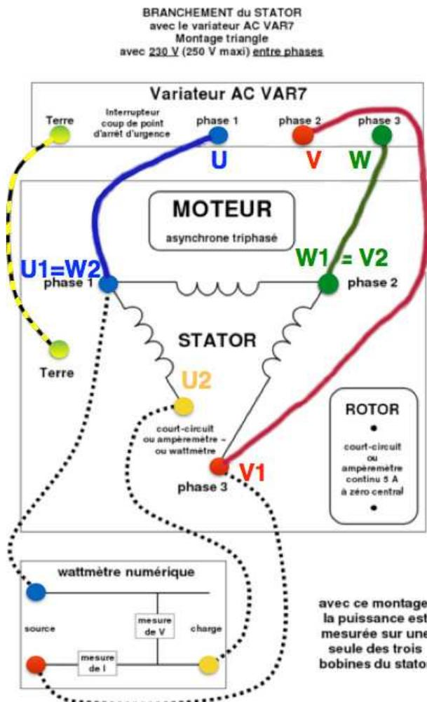
Pour réaliser les branchements adéquats, on se réfère à la figure précédente : on connecte la borne U du variateur à U1 et U1 directement (avec un fil) à W2. On connecte ensuite la borne V du variateur à V1. On connecte la borne W du variateur à W1, puis W1 directement à V2. Pour les branchements au Wattmètre (qui permet de relier U2 à V1 et de fermer le triangle), on se reporte au schéma. C'est normal si on laisse une des quatre bornes de ce wattmètre sans connexion (celle en haut à droite). On
