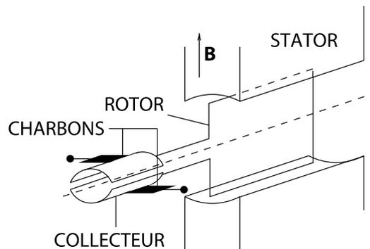
Le collecteur est une pièce tournante. Les charbons sont fixes. Le stator est en général constitué d'un bobinage placé autour de pièces polaires, alimenté par un courant continu.
