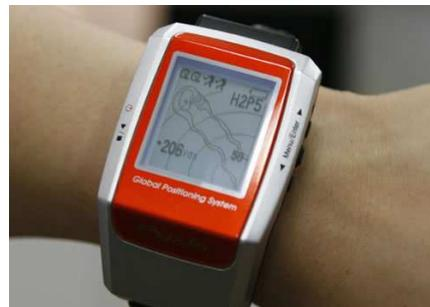
Le principe du positionnement GPS est très proche du principe de triangulation. Le GPS mesure la distance entre l'utilisateur et un certain nombre de satellites de positions connues grâce au temps qu'a mis chaque signal à parvenir jusqu'à lui. On définit ainsi des sphères centrées sur des satellites et dont l'intersection donne la position.
