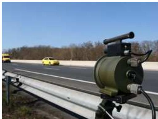
Pour que les mesures réalisées par les radars (fixes ou mobiles) soient exactes, ceux-ci doivent être réglés à 25° par rapport à l'axe du déplacement (arrêtés du 7 janvier 1991 et 31 décembre 2001).
